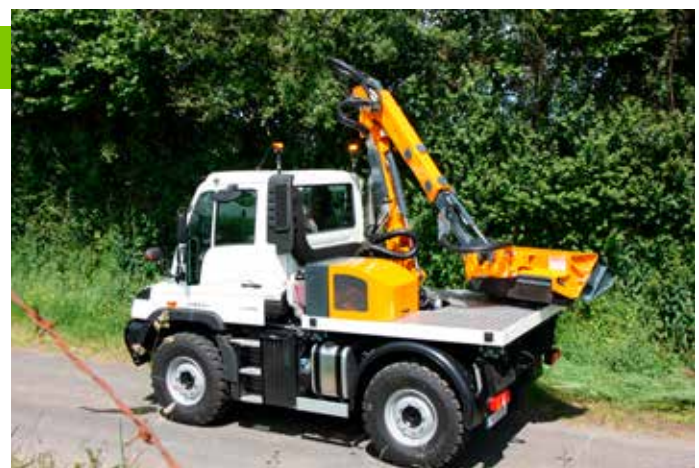
La machine en position transport. Elle est assemblée sur un faux-châssis à dépose rapide par quatre béquilles à manivelle. L'ensemble se monte sur le « châssis boule » du véhicule. Des coquilles de bridage assurent la fixation. Pour le transport, la carcasse repose sur un support.
