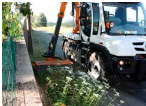
Le chauffeur bénéficie d'une excellente visibilité sur le groupe de broyage au travail.
